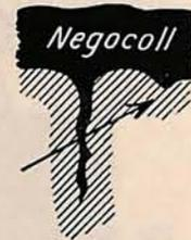
Fig. 90. Falsche Abheberichtung.
